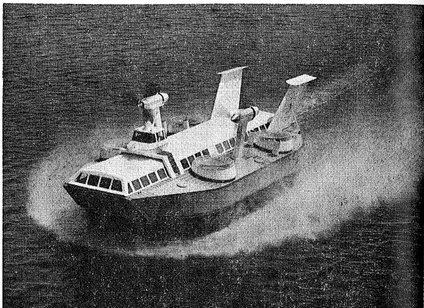
Naviplane type N 300, longueur 24 m, largeur 10,5 m, masse totale 27 tonnes, vitesse maximale 105/115 km/h.
